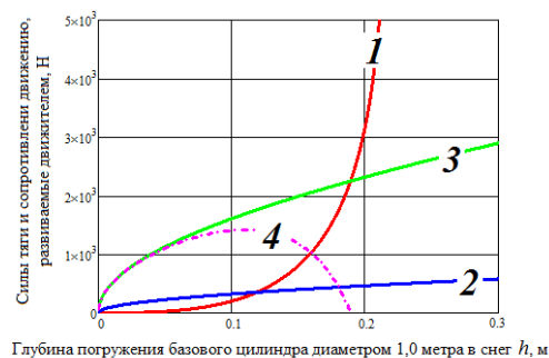
Рис. 2. Изменение сил сопротивления движению и тягового усилия в зависимости от глубины погружения ротора, диаметром 1,0 м. в снежный покров высотой 0,5 м; 1 - суммарная сила сопротивления колееобразованию для начальной плотности снежного покрова равной 350 кг/м³; 2 – сила тяги, развиваемая одной лопастью роторно-винтового движителя; 3 - сила тяги, развиваемая пятью лопастями роторно-винтового движителя; 4 - запас силы тяги при прямолинейном движении.
