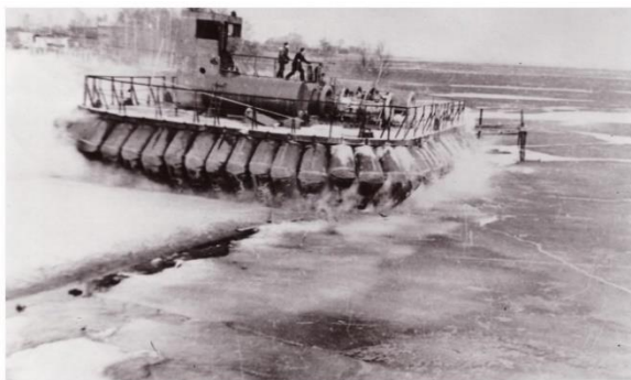
Рис. 4. Спуск на ледяной покров ЛПВП пр. 102 («Торос»)
