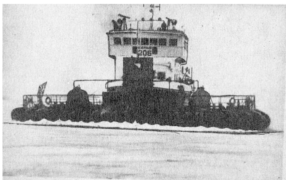
Рис. 5. Движение ЛПВП пр.102 в сплошном льду толщиной 0.85 м в сале с буксиром «Озерный 206» со скоростью 11 км/ч
