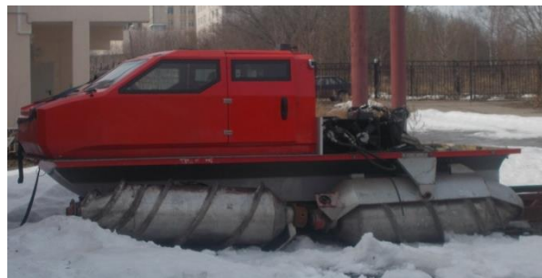
Рис. 17. Прототип универсального спасательного транспортного средства с роторно-винтовым двигателем, производства ФГБУ ВО Нижегородский государственный технический университет им. Р.Е. Алексеева
