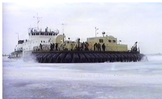
Рис.6. Прокладка канала в сплошном льду составом ЛПВП пр. 107П в сале с ледокольным буксиром «МБ-1215»
