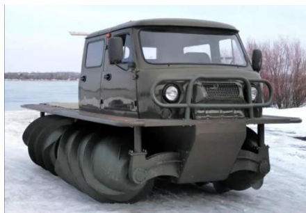
Рис. 16. Шасси с роторно-винтовым двигателем производства ООО «Завод Вездеходных машин»
