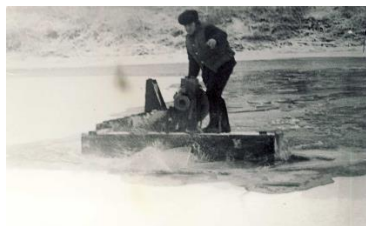
Рис. 3. Модель платформы на воздушной подушке: а), б) Внешний вид; в) Разрушение ледяного покрова
