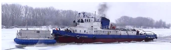
Рис. 8. Непрерывное движение состава ЛПВП + ледокольный буксир во льду толщиной 0.3 м со скоростью 12 км/ч
