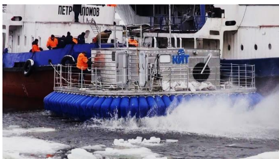
Рис. 7. Внешний вид макета ЛПВП пр. 00702, процесс счаливания с ледокольным буксиром перед испытаниями
