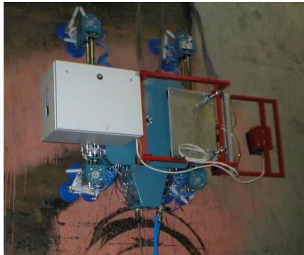
Рис. 3. Мобильный робот вертикального перемещения на вертикальной поверхности
