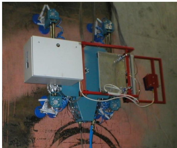
Рис. 3 Мобильный робот вертикального перемещения на вертикальной поверхности
