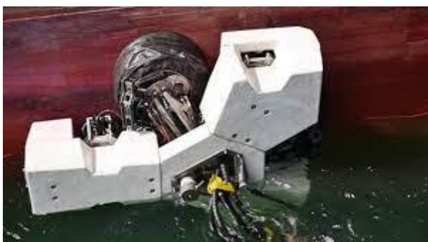
Рис. 1. РТК, разработанный компанией Fleet Cleaner (1)
