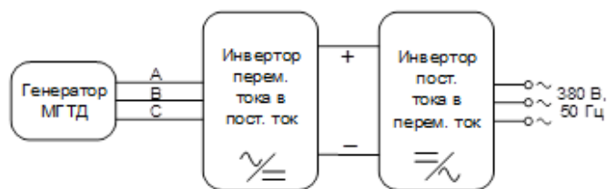
Рис. 1. Функциональная схема силового электронного преобразователя
