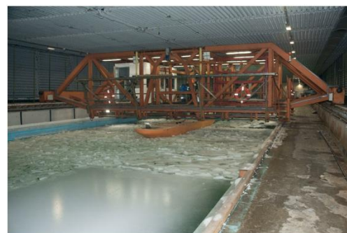
Рис. 2.3.2. Самоходные испытания. Движение в поле восторошенного льда, имитирующее движение в широком канале, проложенном ледоколом пр. 10510 («Лидер») в ледовом бассейне КГНЦ
