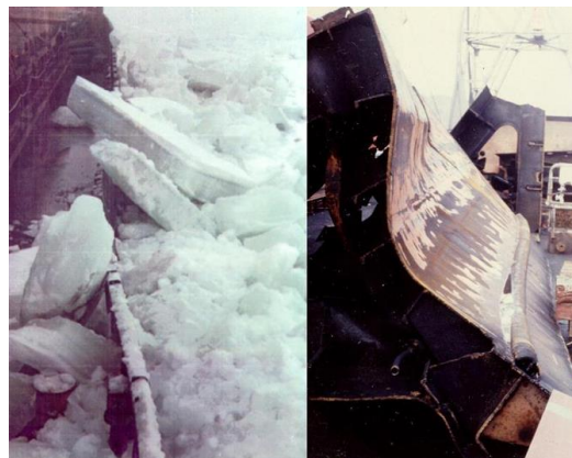
Рис. 2. Картина повреждения прямостенного борта при взаимодействии с ледовым покровом [3]
