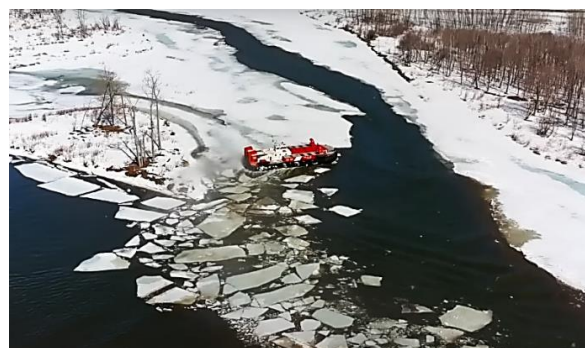
Рис. 2. Разрушение льда на мелководье с выходом судна на остров
