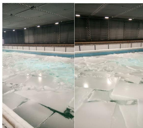
Рис. 2.2.1. Моделирование поля крупнобитого сплоченного (подторошенного) льда в ледовом бассейне КГНЦ
