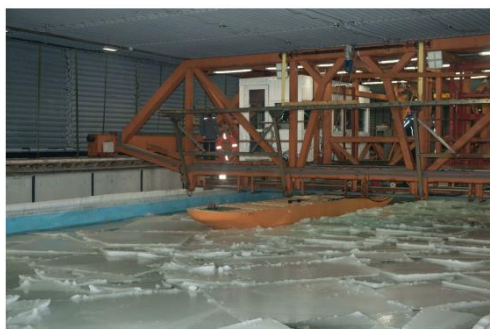
Рис. 2.2.2. Самоходные испытания в ледовом бассейне КГНЦ крупнотоннажного арктического танкера. Сплощенный крупнобитый лед. Толщина льда - 2,0 м. Передний ход. Балластная осадка
