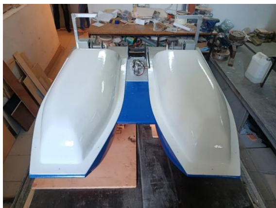
Рис. 3. Промысловый катамаран ПК-2 (вид спереди)
