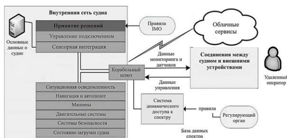
Рис. 2. Архитектура сети для локального мониторинга оборудования автономного судна
