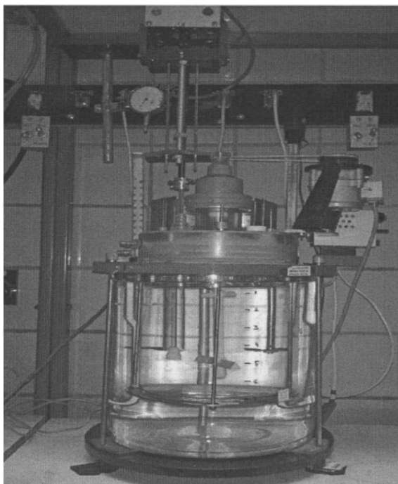
Рис.2. Установка для выращивания монокристаллов \alpha -LiIО 3 (НПО «Полюс», г. Москва)
