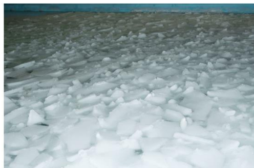
Рис. 2.3.1. Поле восторошенного льда в ледовом бассейне КГНЦ
