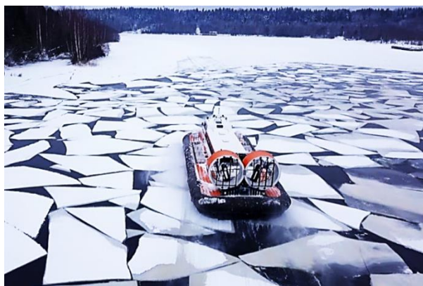
Рис. 1. Разрушение ледяного покрова после двух проходов СВП
