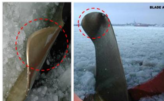
Рис. 2. Повреждение кромок лопасти ЛГВ при ледовом воздействии, по материалам [3]
