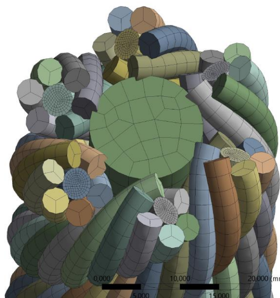
Рис.12 Конечно-элементная модель каната для рассматриваемых вариантов
