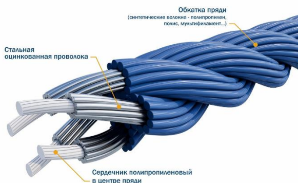
Рис.3 Комбинированный канат типа «Альбатрос»
