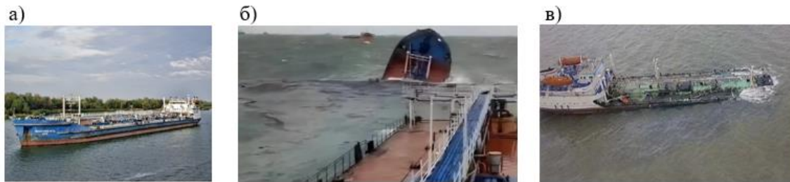
Рис. 3. Перелом корпуса танкера «Волgoneftь»: а – общий вид судна; б – момент аварии; в – оставшаяся часть корпуса
