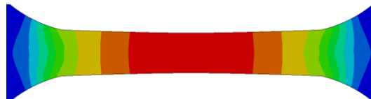
Рис. 12. Поля эквивалентных напряжений: в процессе нагружения: а) t=0.21 ; б) t=0.35 ; в) t=0.70 ; г) t=0.93 ; д) t=0.99
