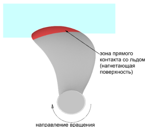
Рис. 4. Рабочий (эксплуатационный) режим взаимодействия лопасти ЛГВ со льдом при положительных углах атаки \alpha(\bar{r}) \geq 0 : (а) - первый тип фрезерования; (б) - второй тип фрезерования [1,3]
