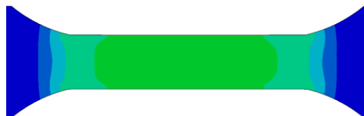
Рис. 11. Поля эквивалентных напряжений: в процессе нагружения: а) начальный шаг нагружения; б) шаг, предшествующий разрушению
