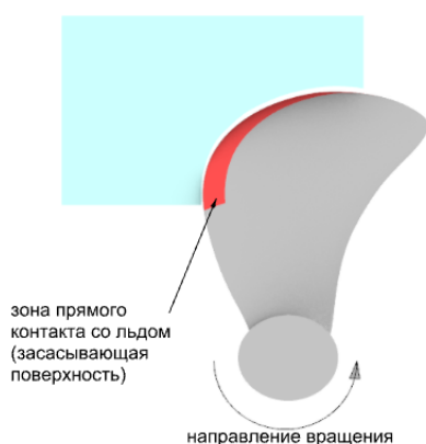
Рис. 4. Рабочий (эксплуатационный) режим взаимодействия лопасти ЛГВ со льдом при положительных углах атаки \alpha(\bar{r}) \geq 0 : (а) - первый тип фрезерования; (б) - второй тип фрезерования [1,3]
