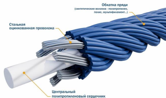
Рис.1 Комбинированный канат типа «Геркулес»
