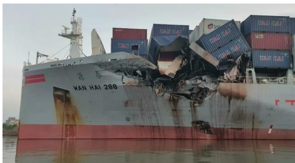
Рис. 1. Нарушение целостности корпуса судна при аварийном столкновении
