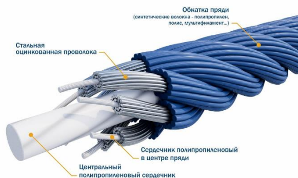
Рис.2 Комбинированный канат типа «Нептун»
