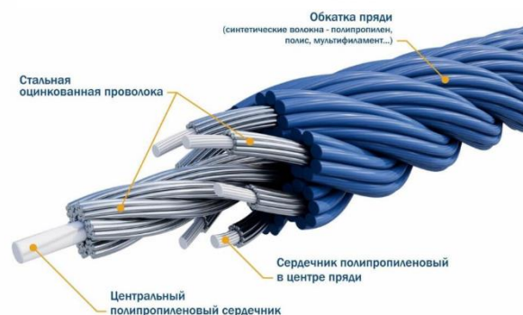
Рис.4 Комбинированный канат типа «Тайфун»
