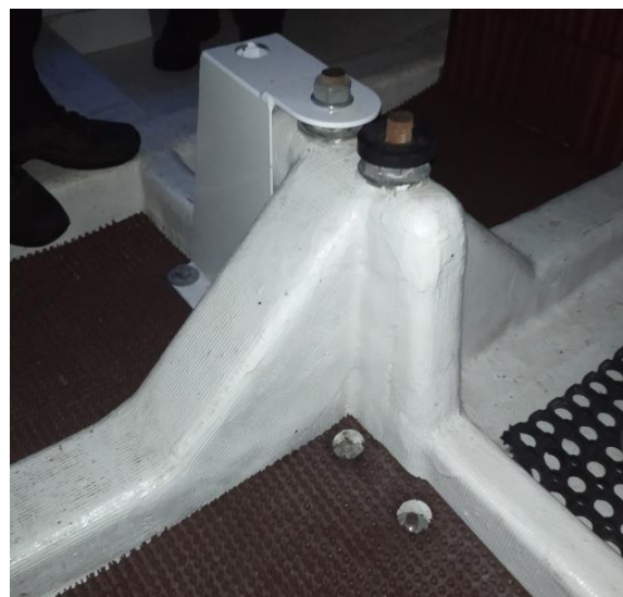
Рис.24. Узел крепления балластного плавника
