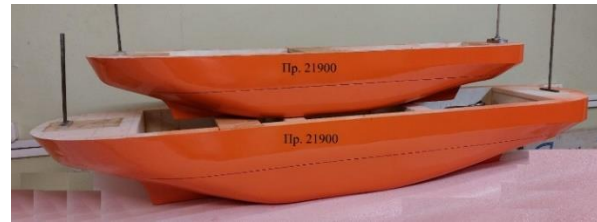
Рис. 4. Модели ледокола проекта 21900 в разных масштабах
