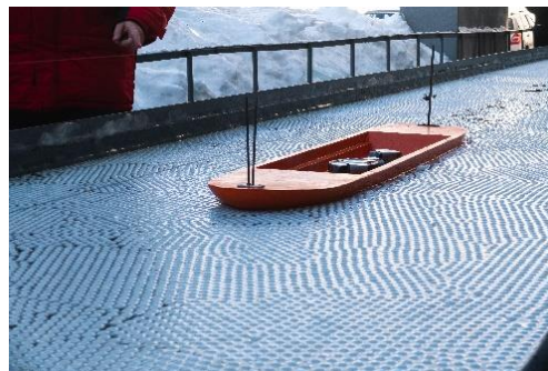
Рис. 3. Испытание модели ледокола проекта 1191 в композитной модели льда
