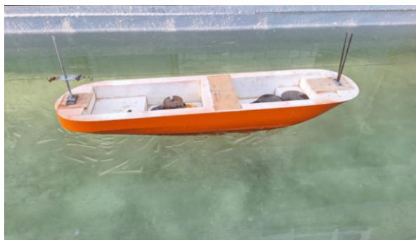
Рис. 4. Фрагмент испытаний движения модели ледокола проекта 21900
