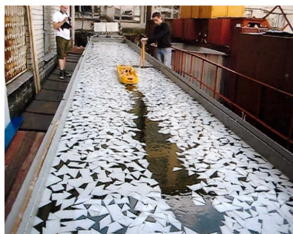
Рис. 1. Общий вид бассейна при испытаниях в битом льду
