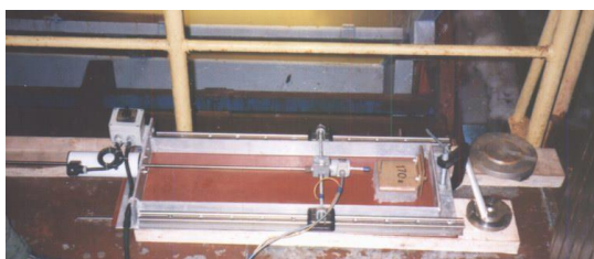
Рис.1 Измерение коэффициента трения льда об обшивку модели
