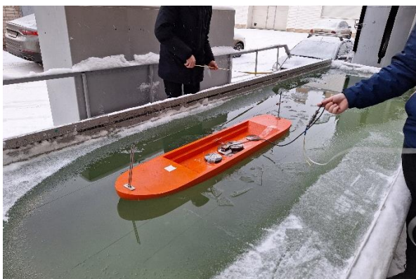
Рис. 5. Фрагмент испытаний движения модели ледокола проекта 1191
