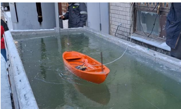
Рис. 6. Фрагмент испытаний движения модели ледокола проекта 16
